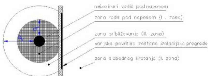
Slika 2. Ograničavanje zone rada pod naponom zaštitnim izolacijskim pregradama
