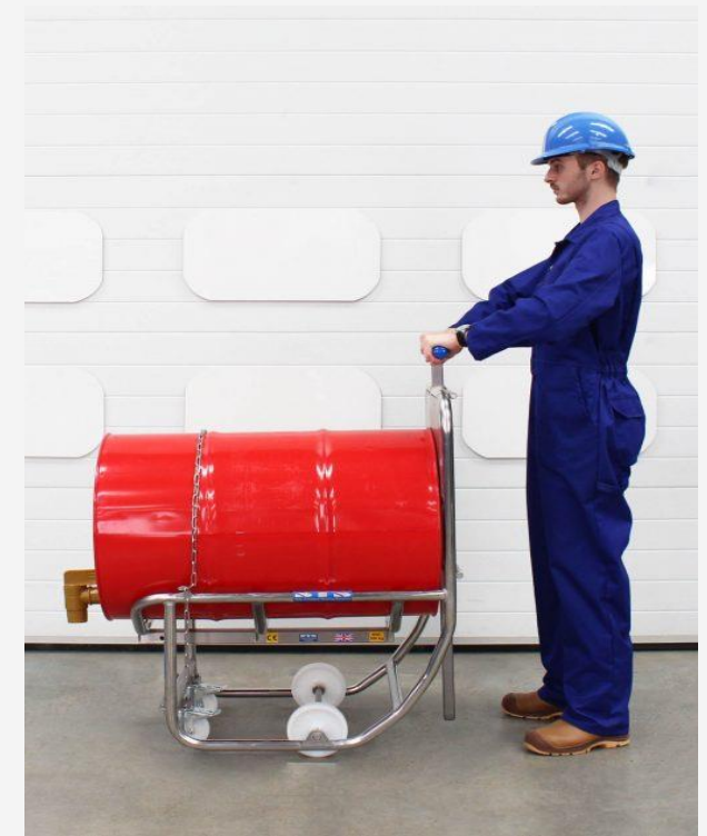
Primjer ispravnog transporta valjkaste ambalaže
