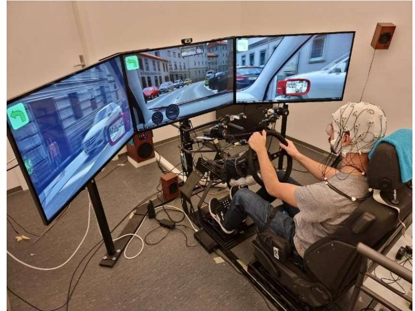
Slika 5: Mjerenja izvedbe vozača na naprednom simulatoru vožnje u kontroliranim uvjetima
