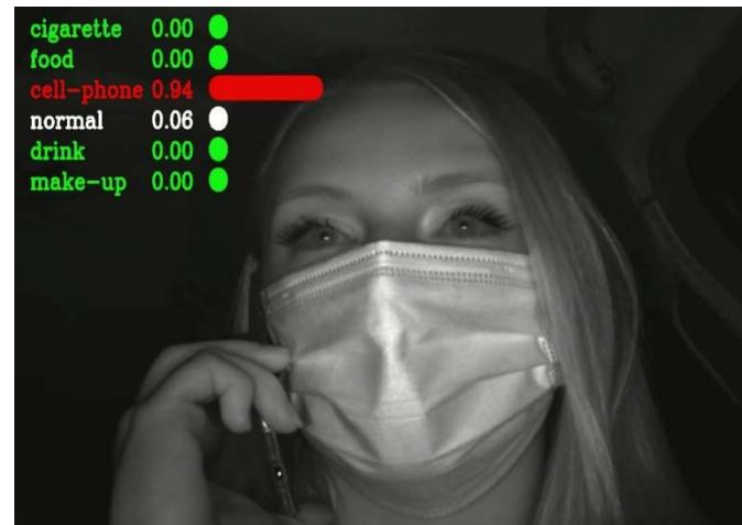
Slika 6: Mjerena izvedbe vozača u realnim uvjetima s prikazom izlaznih vrijednosti iz sustava
