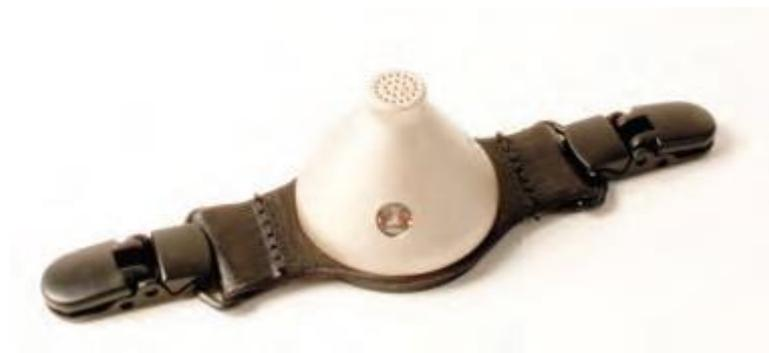
**Dozimetar** mora zadovoljavati normu IEC 61252 s tim da prednost imaju dozimetri koji zadovoljavaju zahtjeve za zvukomjere klase 1.
