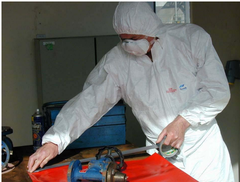
Slika 11.3 Upotreba trake i polietilenske folije za zaštitu radnog područja prije čišćenja azbestnih brtvi s ventila
