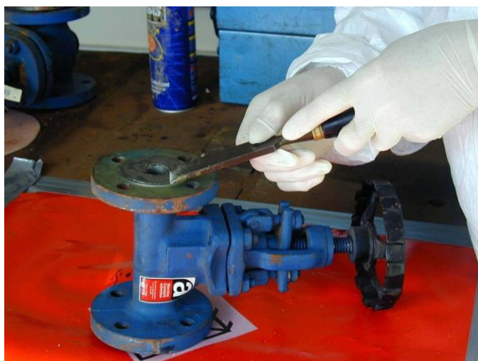
Slika 11.5 Za čiščenje azbestnih brtvi i ostataka s ventila koristite samo ručni alat.
