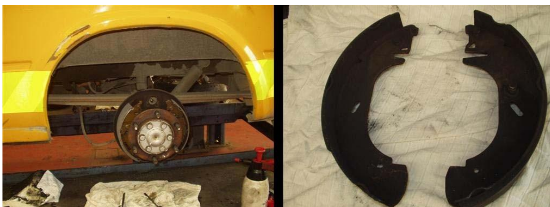
Slika 18.1 Azbest u kočionim papučama na kamionu
