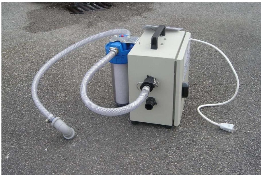
Slika 8.1 Filtracija vode za ispuštanje iz dekontaminacijske jedinice. Fotografiju je dostavio Izvršni odbor za sigurnost i zdravlje na radu Ujedinjenog Kraljevstva (UK HSE).
