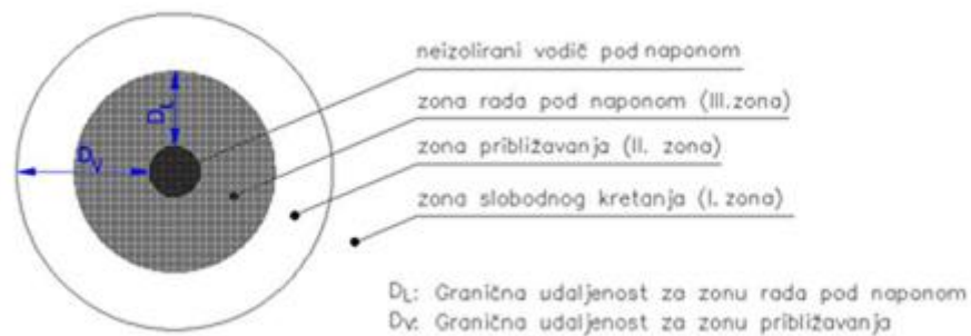
Slika 1. Zona rada pod naponom i zona približavanja
